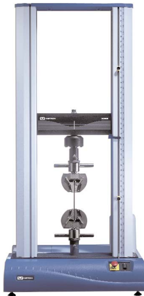
▲ Modelo 3369 de Instron, en azul cobalto, configurado para ASTM D 638, realizando un ensayo de tracción en plástico
